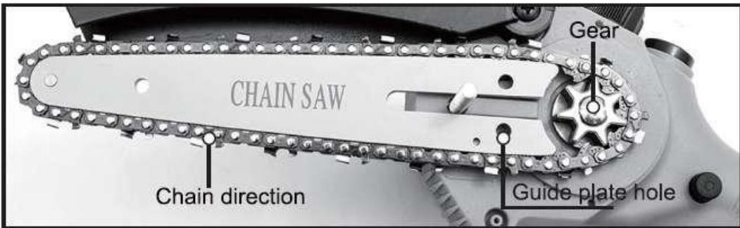
**Pokud nelze otvor ve vodicí desce zasunout do těla pily, je třeba řetěz a vodicí lištu rádně zašroubovat a nejprve vyjmout řetěz z těla pily.**
