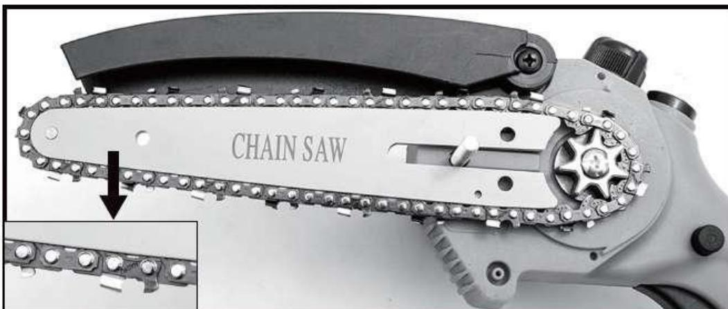
**Jeden konec řetězu pily nasaděte na horní část vodicí lišty a druhý konec kolem řetězového kola.**
