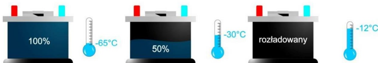
Temperatura krzepnięcia elektrolitu w zależności od stopnia rozładowania akumulatora.
